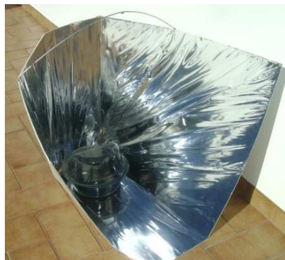
Fig.17 Cocina solar con concentrador de cartón [2]
